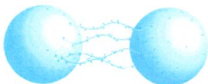
Рис. 1: Флокуляция с линейным катионным полиакриламидом
