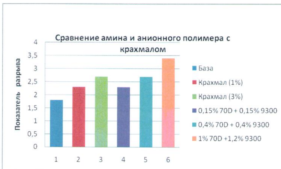
Рис.2 Комбинация первичного амина и анионного полимера
