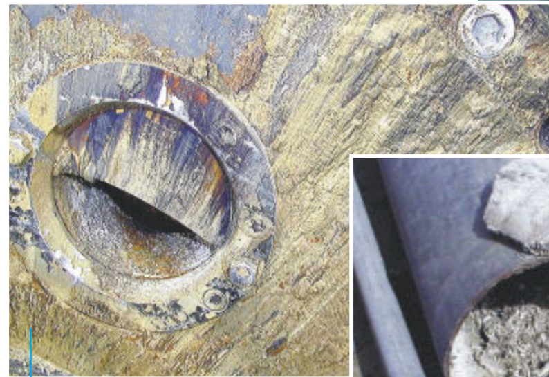
Образование отложений на торцевой стенке центрифуги
